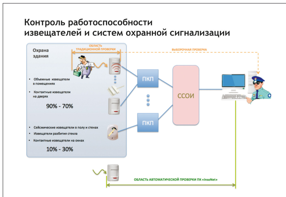
Рис. 5. Контроль извещателей и охранной сигнализации
