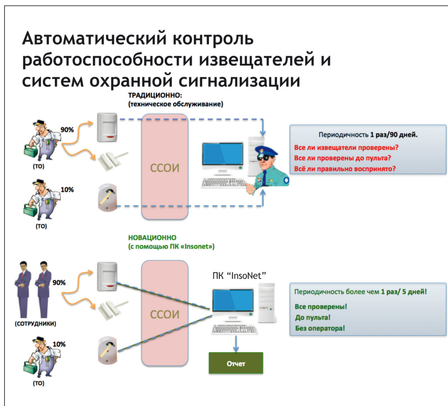
Рис. 6. Автоматическая проверка извещателей и охранной сигнализации
